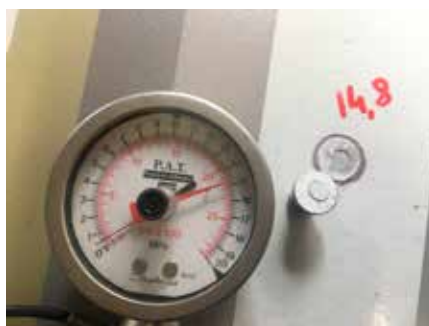
Voorbeeld van een pull-off test
